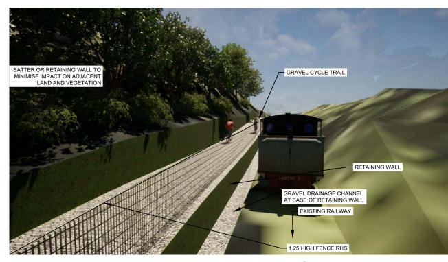
RETAINING WALL - RAIL IRONS (1.0m WALL) VISUALISATION -NTS
