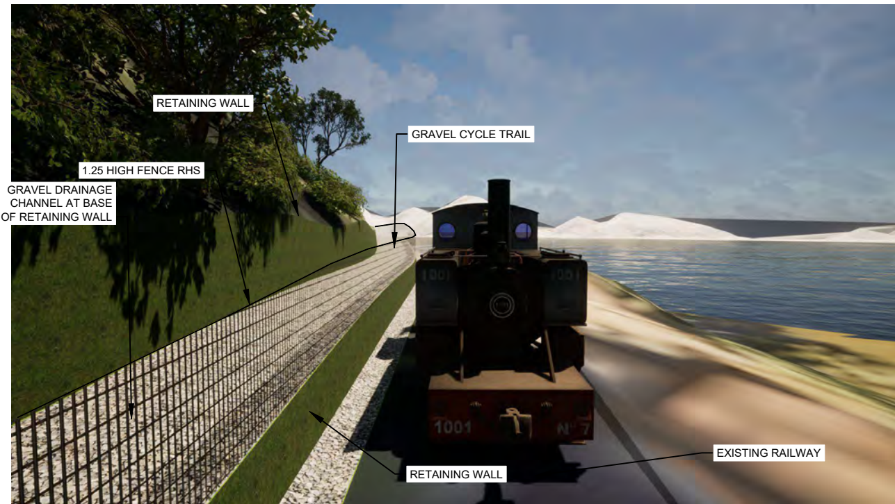
VISUALISATION - COMBINATION RETAINING WALL (D) NTS
