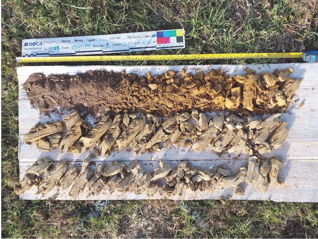
Box 1 - 0.00mbgl to 3.00mbgl
